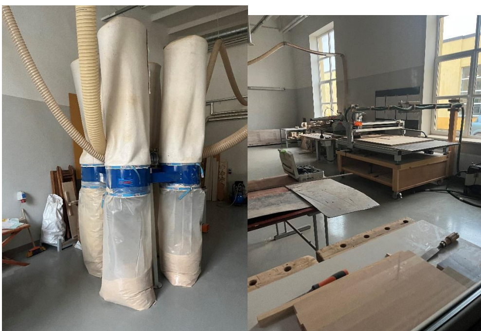
3.6.7. att. Galdniecības darbnīca (pa labi) un putekļu un atkritumu uzkrāšanas iekārta (pa kreisi).
